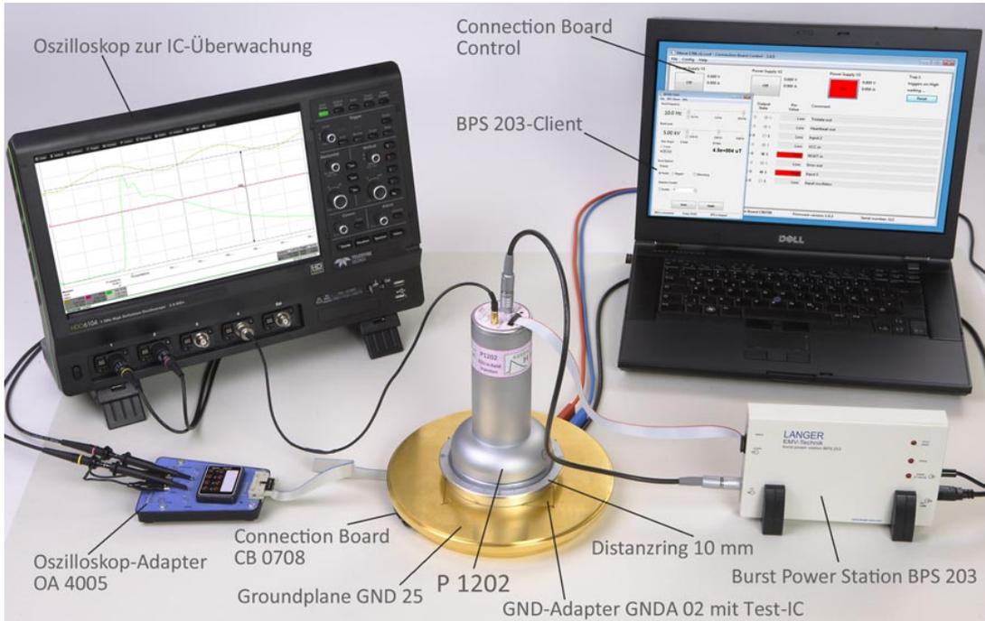
Messanordnung mit P1202 L-ESD (Die mit \* gekennzeichneten Geräte sind nicht im Lieferumfang enthalten.)
