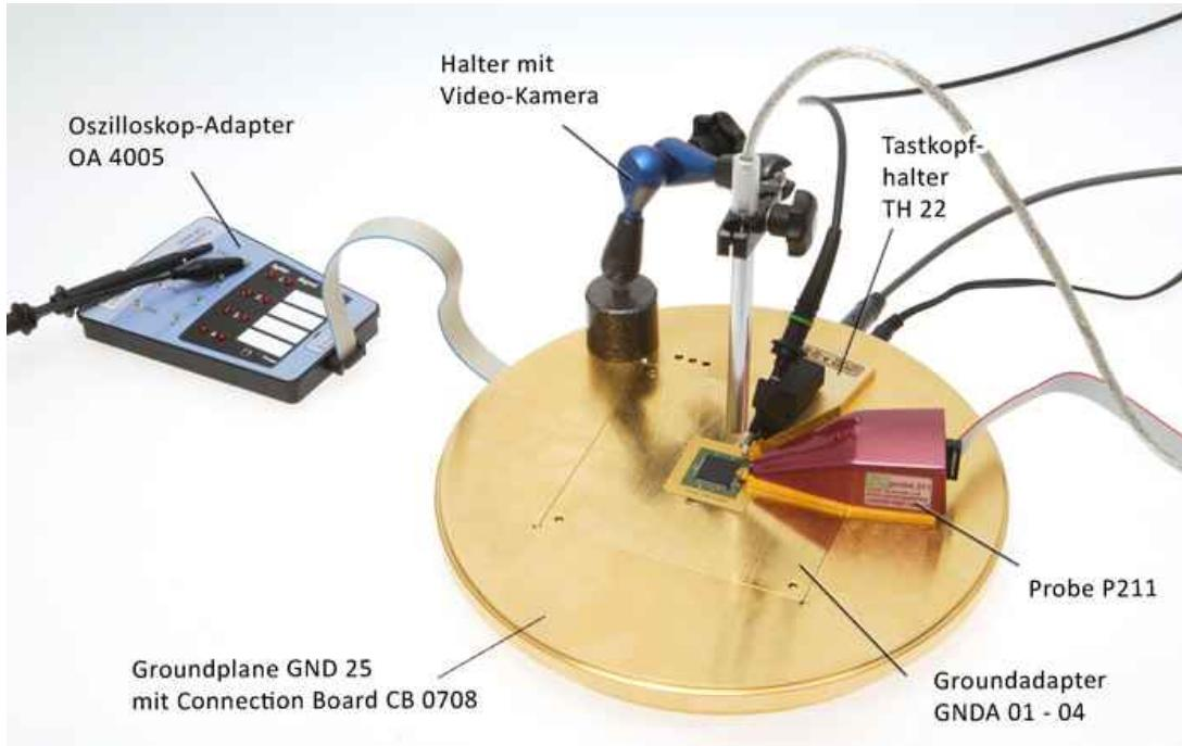
Schema Messanordnung IC-Testumgebung ICE1 mit externen Geräten
