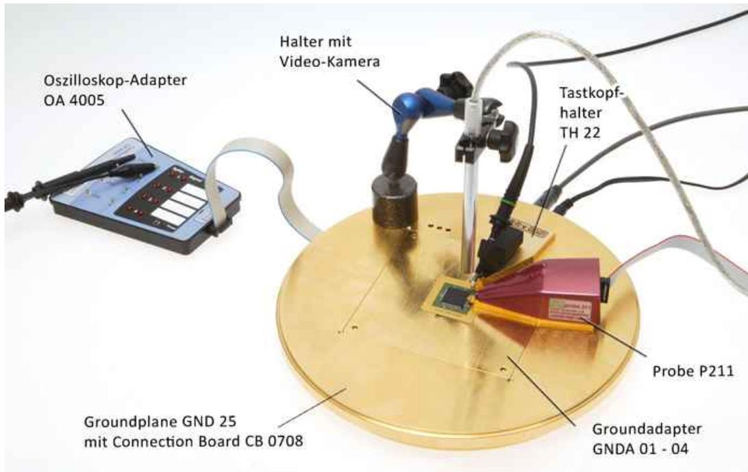
Schema Messanordnung IC-Testumgebung ICE1 mit externen Geräten
