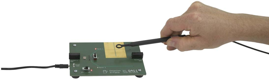
Erfassen von Störaussendung - E-Feldsonde RF-E 05 über
