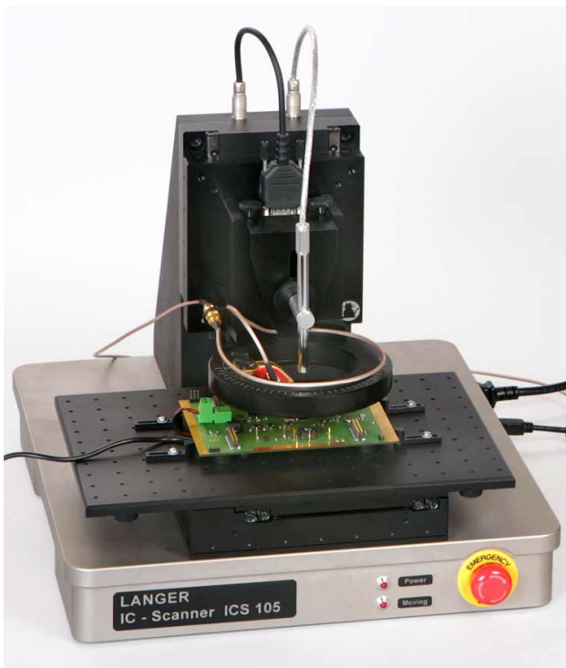
ICS 105 mit Universalhalter UH DUT und Prüfling
